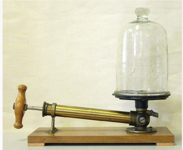
[Fig. 1] Kolben-Luftpumpe : 20세기초 진공상태의 구현을 간단히 보여주 기 위해 고안된 진공 장치이며, 오늘날에는 최첨단 이온 펌프를 이용하여 10^{-11} Torr의 극진공을 구현하고 있다.
