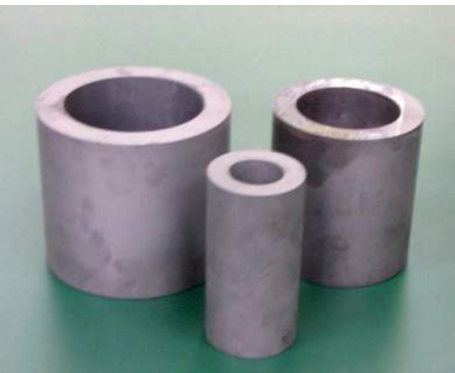
[Fig. 3] SiC II의 Stock Tube 형상
