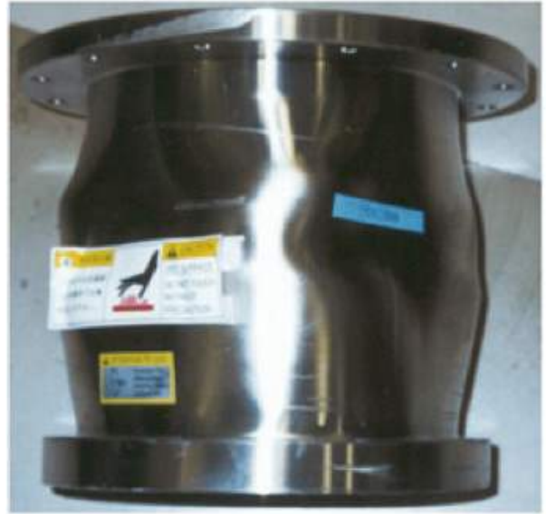
[Fig. 1] 내부 고압으로 인한 터보분자펌프 하우징 손상
