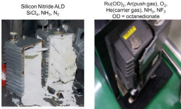
[Fig. 5] 공정으로 인해 진공 펌프 내부에서 형성되는 공정 부산물과 폭발
