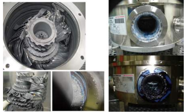
[Fig.10] 이온 주입 장치와 LCD 건식 식각 장비에 사용된 터보 분자 펌프들
